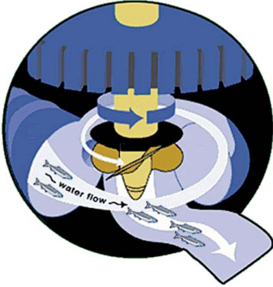
Şekil 3 - Türbinlerden balıkların geçişi
