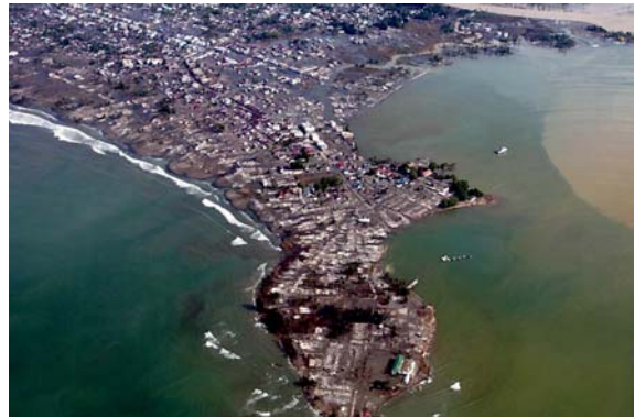
Şekil 7 - Meulaboh (Sumatra) Şehrinin Kuş Bakışı Görünüşü. Asıl Merkezinin Yer Aldığı Bu Alanda Buruna Çarpan Tsunami Dalgaları Difraksiyon Yaparak Yapıların Tamamen Yıkılmasına ve Can Kayıplarının Yüksek Olmasına Neden Olmuştur.
