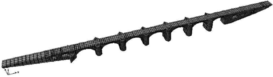
Şekil.10 Köprü gövdesi 3 boyutlu sonlu eleman modeli.
