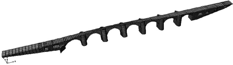
Şekil.11 Birinci serbest titreşim mod biçimi ( T_1 = 0.137 s)
