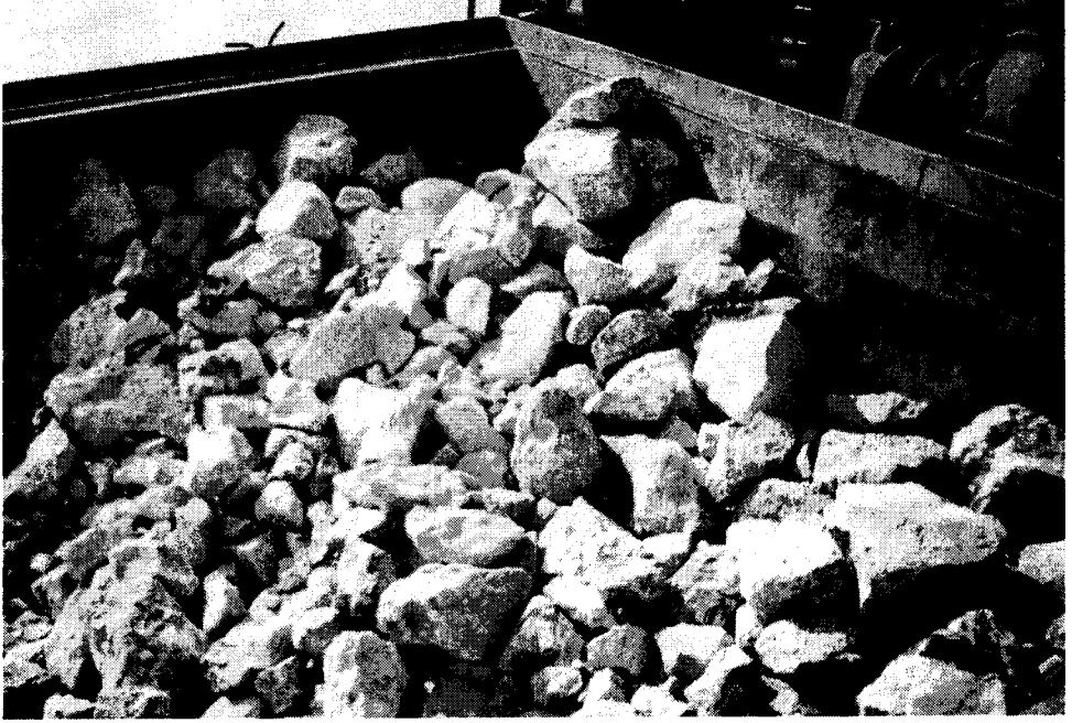
Resim 9.4.1 Boru üstü son örtü malzemesi (45 kg anroşman)
