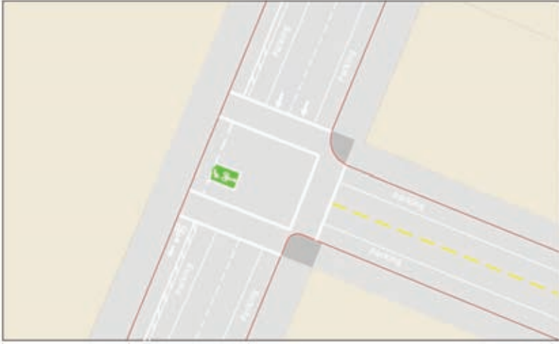
Şekil 7. Kavşaklarda bisikletlerin güvenli geçişi için düzenlenen bekleme alanı [2]
