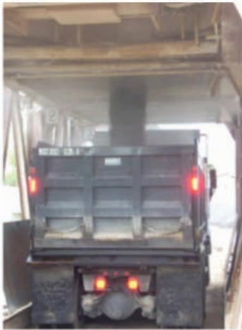
Şekil 7. Plentte asfalt karışımlar kamyonlara doldurulurken
