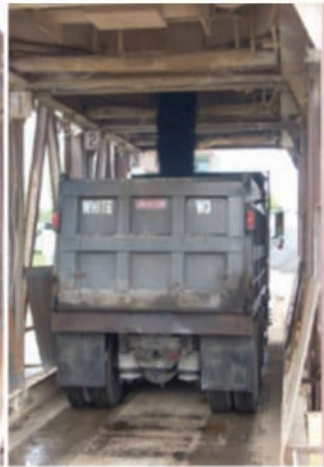
Şekil 7. Plentte asfalt karışımlar kamyonlara doldurulurken
