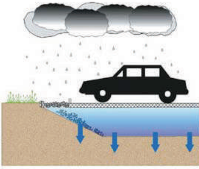
Şekil 1. Geçirimli asfalt uygulanmış bir yol kesiti
