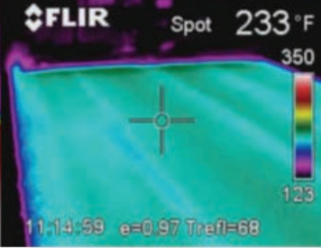
Şekil 9. Asfalt karışımlar yola serildikten sonra termal kamera ile alınan sıcaklık görüntüleri
