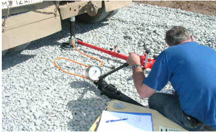
Şekil 3.14 Plaka yükleme deneyi uygulama aşaması
