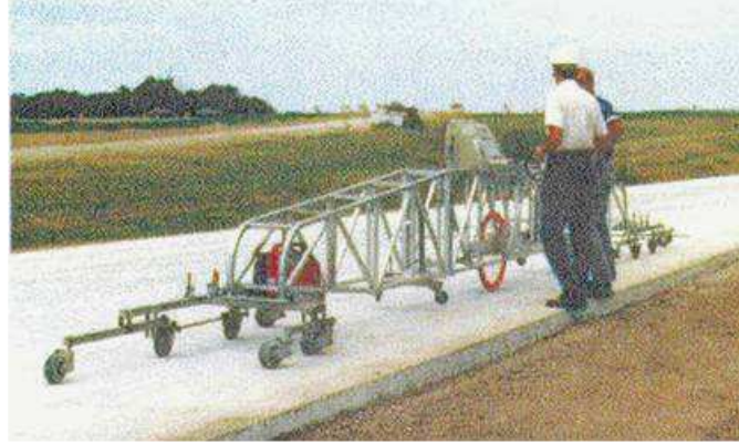
Şekil 5.19 Yüzey düzgünlüğünün ölçülmesini sağlayan tekerlekli bir alet
