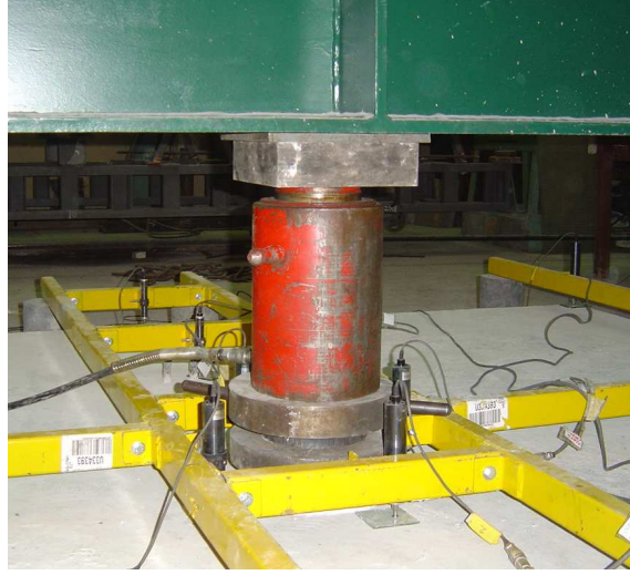
Şekil 7.18 Yük vereninin yerleştirildiği plak merkezi ve monte edilen transdüserler [17]
