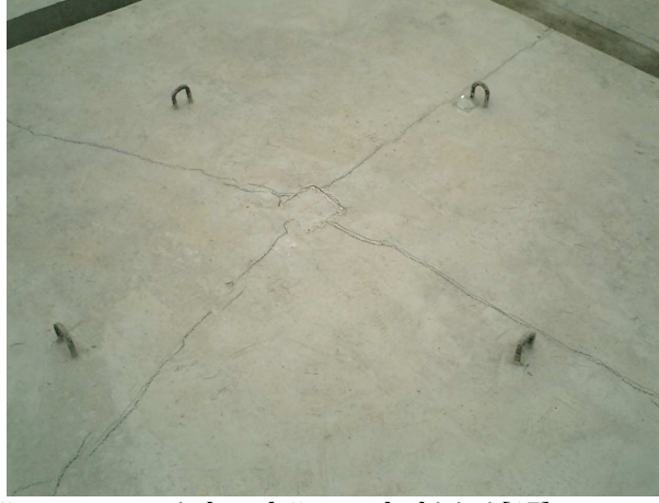
Şekil 7.21 P2 plağının üst yüzeyinde çatlağın yayılış biçimi [17]
