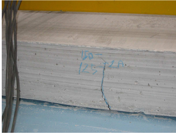
Şekil 7.20 b) P9 plağında Y eksenine paralel kenarın ortasında gelişen çatlak [20]
