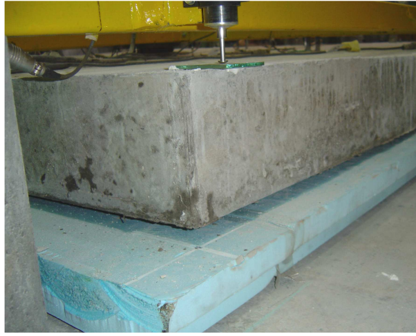
Şekil 7.22 P2 plağının köşesinde düşey yerdeğiştirme (kıvrılma) bölgesinin yakından görünüşü [17]
