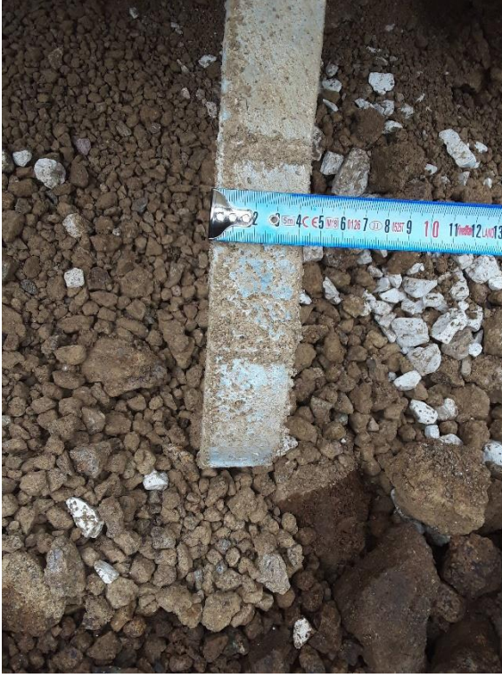
Şekil-5: Zemin donatı şeritleri genişliği ve et kalınlığı
