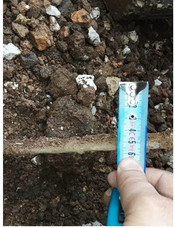
Şekil-5: Zemin donatı şeritleri genişliği ve et kalınlığı
