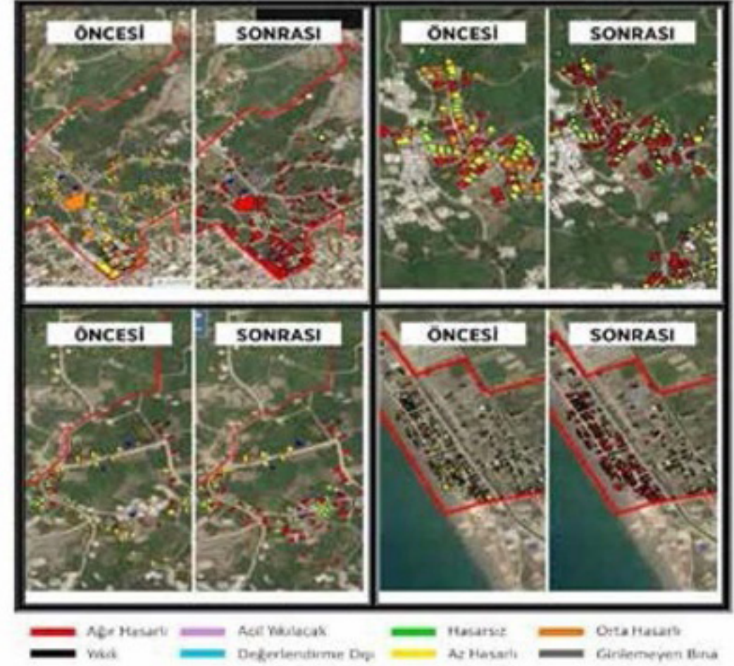
Fotoğraf-1: 20 Şubat Samandığ Depremi Öncesi (19 Şubat) ve sonrası (22 Şubat) yapıların hasar durumları
