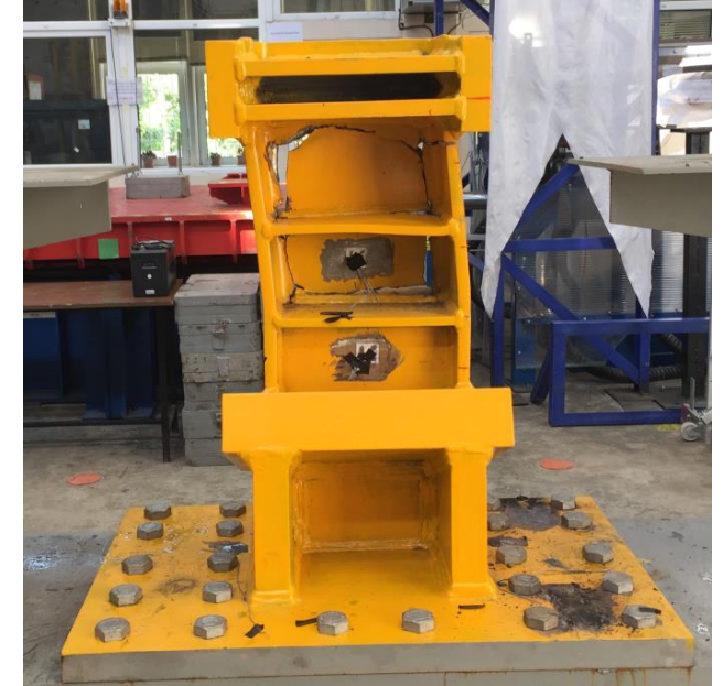
b) Bağ kirişi gövdesinde kaydedilen kayma yerdeğiştirme
