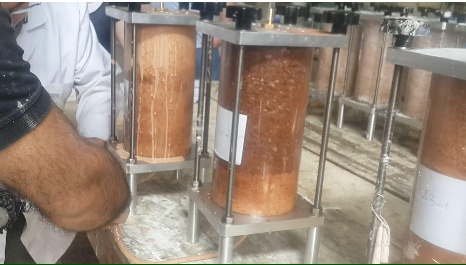
Silindir enjeksiyon deneyi
