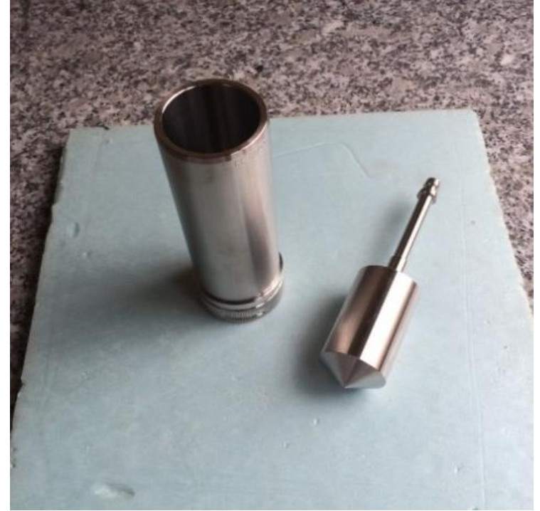
Rotasyonel reometre ve eşmerkezli silindirik ölçüm ucu
