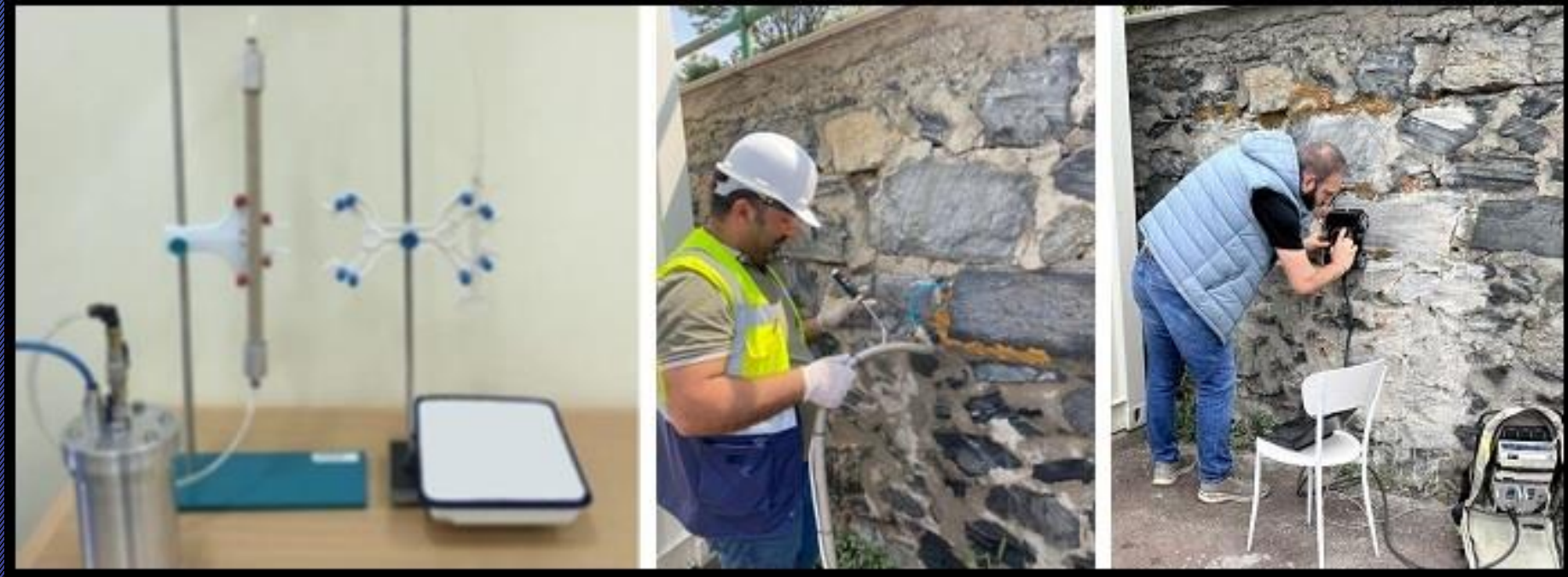
Kan katkılı enjeksiyon malzemesinin deneyleri ve yapıda uygulanması
