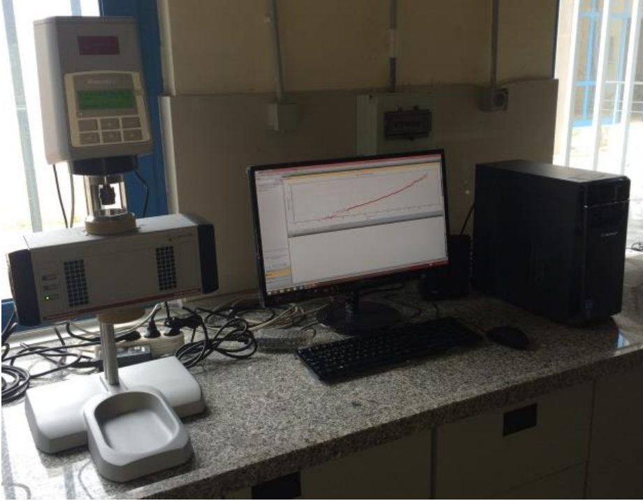
Rotasyonel reometre ve eşmerkezli silindirik ölçüm ucu
