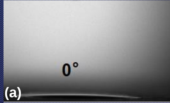
Harç numunelerindeki temas açısı (a) REF, (b) Kan katkılı harç
