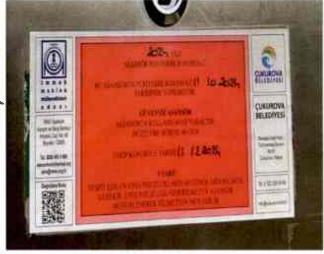
Resim 1b: Asansör periyodik kontrol belgesi (kullanımı engellenmiş)
