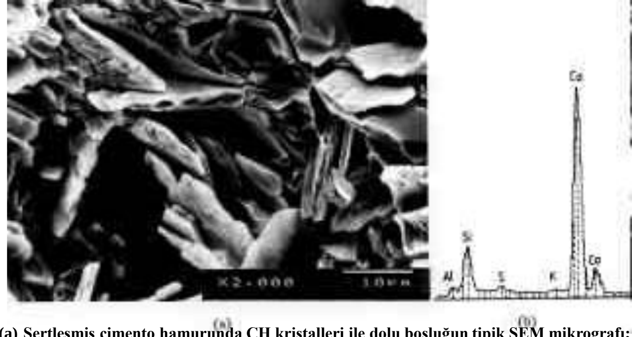
(a) Sertleşmiş çimento hamurunda CH kristalleri ile dolu boşluğun tipik SEM mikrografı; (b) ve (b) CH kristallerini teyit eden EDX spektrumu
