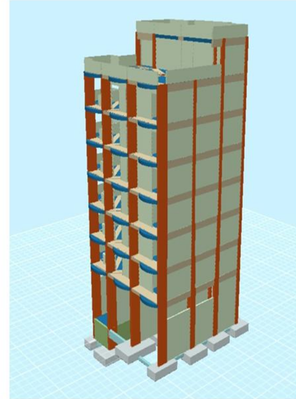
Yerinde Kaçak olarak 3 kat fazla yapılan bina modeli Binaya Proje harici asansör eklenmiştir
