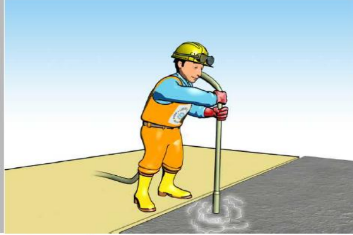
Resim 8: Vibrasyon uygulamasında kullanılan vibratör tipi beton tabaka kalınlığına göre seçilmelidir.
