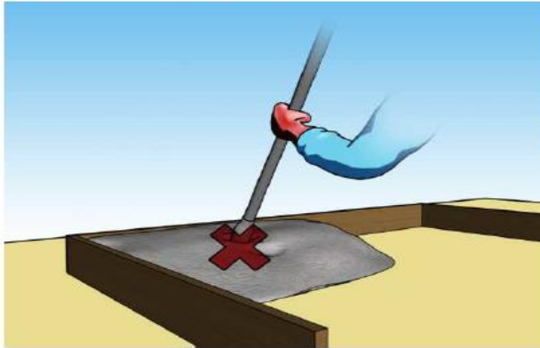
Resim 6: Beton yatay yönde vibratör ucu ile taşınmaz.
