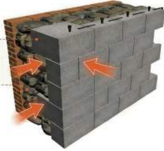
Sandık duvar: Üç cidarlı (arası moloz taş ve harç dolu)
