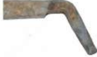
2. Agraf (Kanca): Duvar yüzeyine veya diğer hatillara tutunmayı sağlayan kıvrımlı uç.
