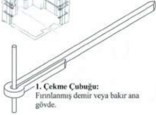
2. Agraf (Kanca): Duvar yüzeyine veya diğer hatillara tutunmayı sağlayan kıvrımlı uç.
