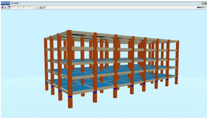
Şekil 29.5 Kath İzolatörlü Yapının Modellenmiş 3d Görünüşü
