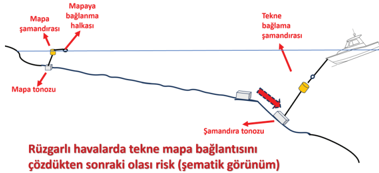
Şekil 19 Rüzgârlı Havalarda Teknenin Kıçtaki Mapa Bağlantısını Çözmesi Sonrası Olası Kayma Riskinin Şematik Görünümü
