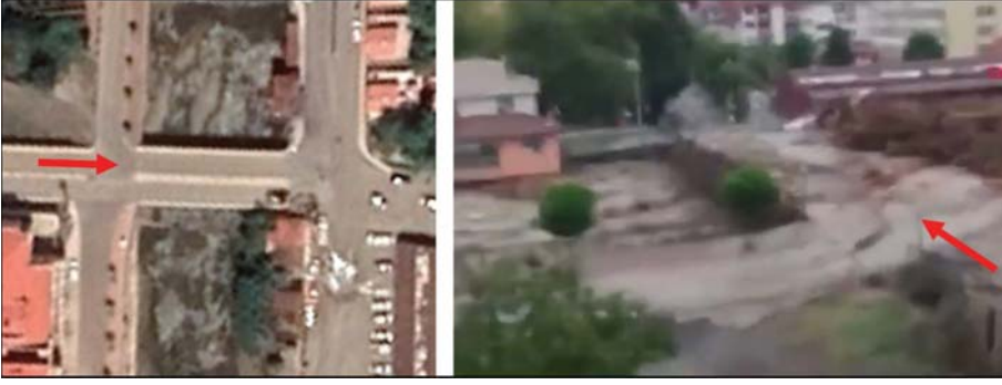
Fotoğraf 3 - Köprü Kesitini Daraltan Yapılar
