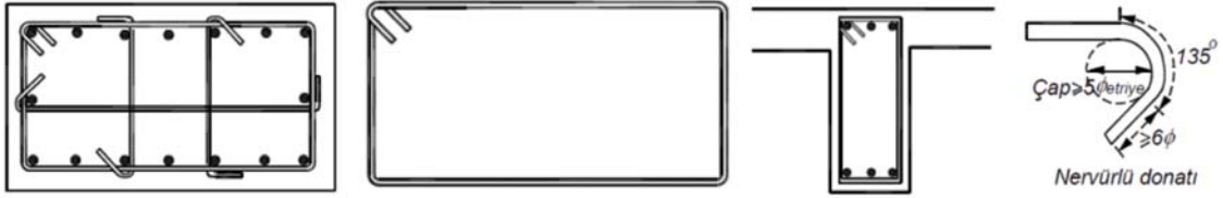
Şekil 23 - Özel deprem etriyelerinin uçlarının 135 derece bükülmesi (TBDY, 2018)
