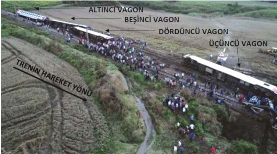
Resim 10c - Trenin son dört vagonunun pozisyonları ve rayların durumu (Vagonların pozisyonları olaydan hemen sonraki halinde, bu fotoğraf muhtemelen olay akşamı çekilmiştir.)
