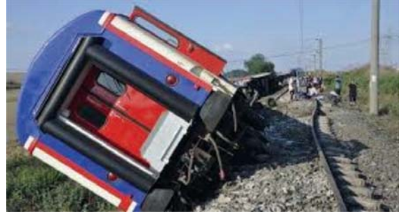
Resim 9b - Menfezi geçen altıncı vagonun tekerlekleri sol (kuzey) rayı aşmış raydan çıkarak eğik pozisyonda durmuştur (yakından vagonun arkadan görünümü).
