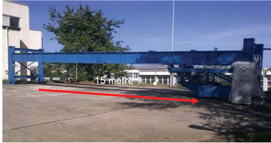
Şekil 2 - KTÜ- Dinamik simülâtör. Arazide beton kaplamalar üzerinde hareketli 9 ton (W18 KİP dingil) yük uygulaması
