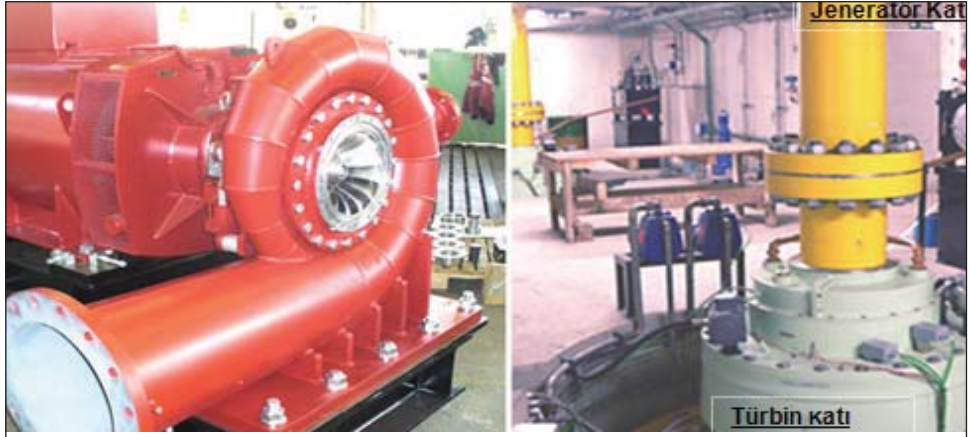
Şekil 2 - a) Yatay eksenli türbin. b) Düşey eksenli türbin. ('Google' görselleri)
