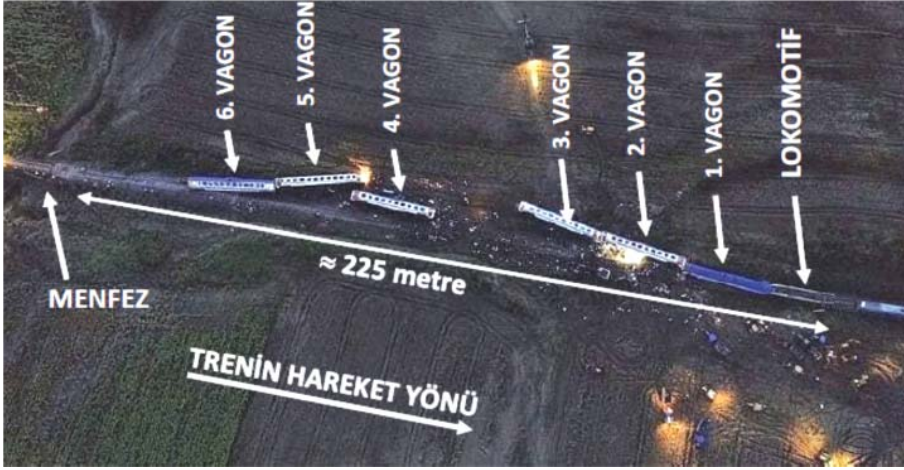
Resim 5 - Trenin son üç vagonu menfezi geçtikten sonra raydan çıkmış ve bütünden koparak devrilmiştir.
