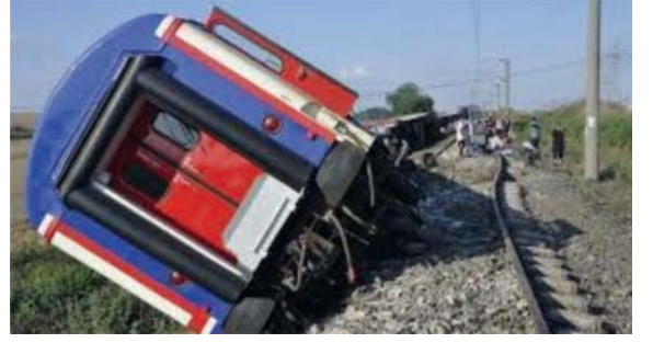
Resim 9b - Menfezi geçen altıncı vagonun tekerlekleri sol (kuzey) rayı aşmış raydan çıkarak eğik pozisyonda durmuştur (yakından vagonun arkadan görünümü).
