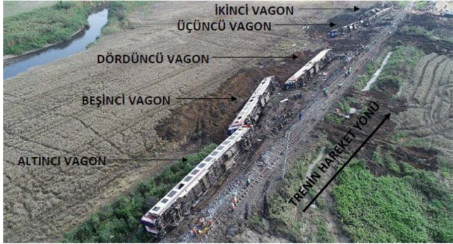
Resim 10b - Trenin son beş vagonunun pozisyonları ve rayların durumu (Vagonların pozisyonları olaydan hemen sonrakilerden kısmen farklı olduğundan, bu fotoğraf muhtemelen olayın ertesi günü çekilmiştir. Lokomotif ve birinci vagon olay yerinden uzaklaştırılmıştır.)
