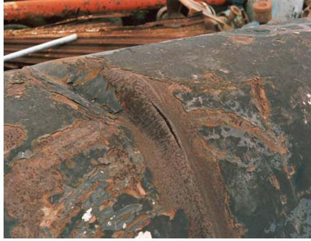
Şekil 4 - Mexico City depreminde dalga yayılımı sebebiyle meydana gelen çelik boru hasarı
