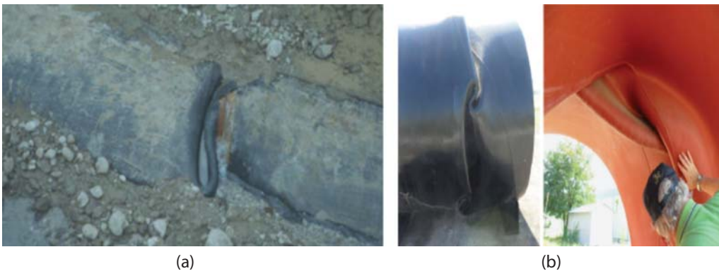
Şekil 8 - a) Borunun üst üste binmesi, b) boru çapında meydana gelen azalma
