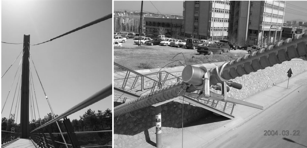
Şekil 4. Kablo titreşim deneyleri.
