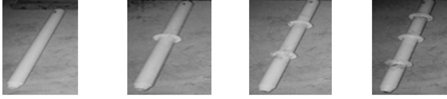
**Şekil 1.** Deney numunelerinin takviye şekilleri
