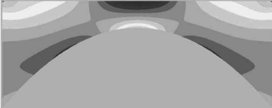
Şekil 5. Düzgün yayılı düşey yüklerden ( w = 1 \text{ kN/m} ) dolayı tek açıklıklı tarihi bir köprüde ( R = 3 ) oluşan eksenel gerilme dağılımı.
