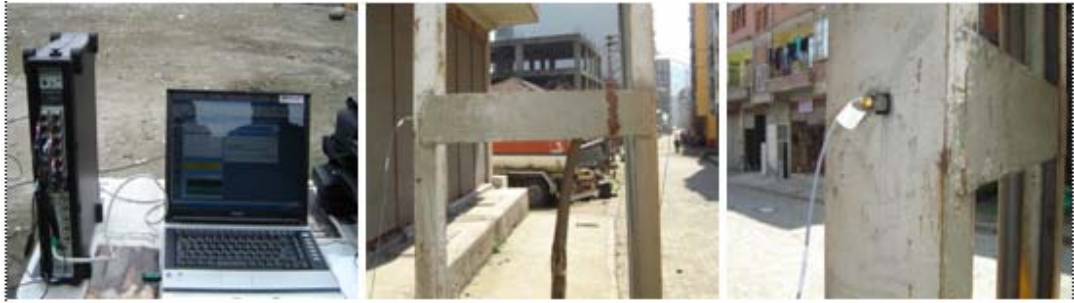
Şekil 4. Veri toplama ünitesi ve ivmeölçer.
