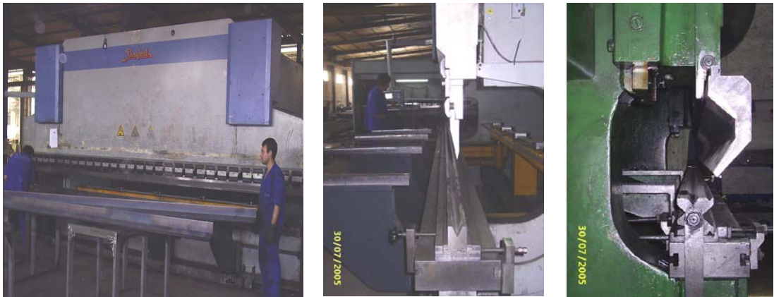
Resim 2: Presle kıvrırma işleminde kullanılan baskı tezgahı ve kalıpları
