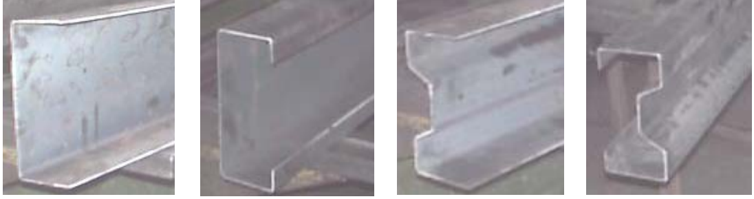
Resim 3. Presle bükerek şekillendirilmiş kesit tipleri, [3].
