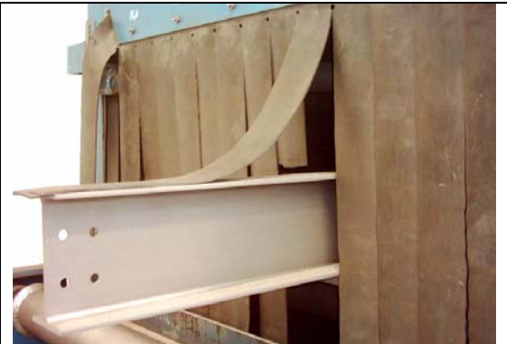
Resim 9: Kumlama makinesinden çıkan malzemenin cıvata delikleri hazır, [9]
