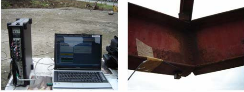
Şekil 4. Veri toplama ünitesi ve ivmeölçer.
