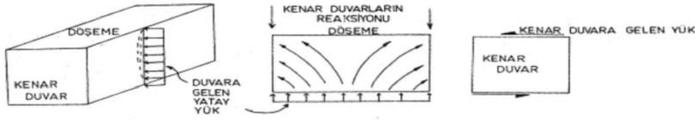
Şekil 7 - Yatay yüklerin duvarlarda oluşturduğu davranış
