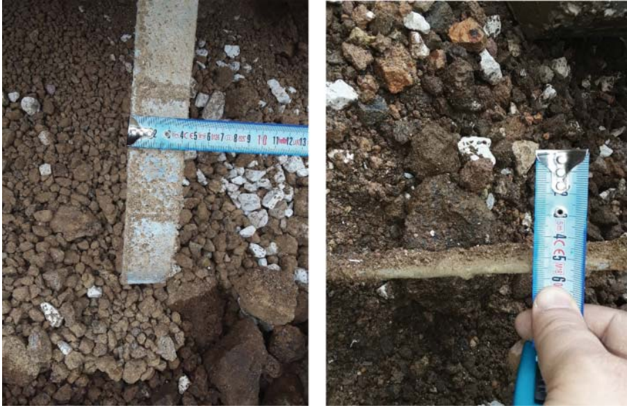
Şekil 5 - Zemin donatı şeritleri genişliği ve et kalınlığı
