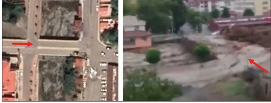
Fotoğraf 3 - Köprü Kesitini Daraltan Yapılar
