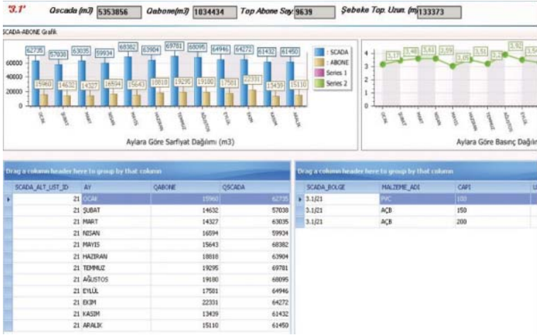
Şekil 4 - SCADA,GIS ve Abone entegrasyonu ile Abone Detayları görünümü
