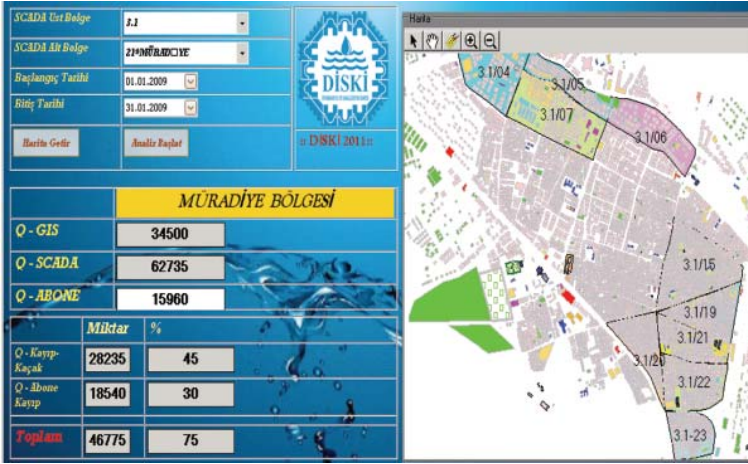
Şekil 2 - Scada,GIS ve Abone entegrasyonu ile Kaçak Analizleri görünümü
