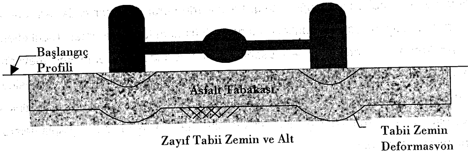
Şekil 1. Zayıf Taşıma Kapasiteli Taban Zeminine Bağlı Tekerek İzi Oluşumu
