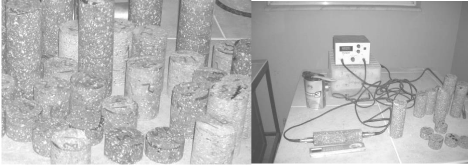
Şekil 3. Hazırlanmış karot numuneleri ve ultra ses darbe testi
