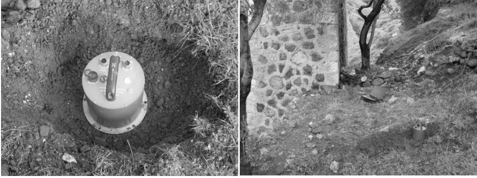
Şekil 5. Zeytinler Köprüsünde mikrotremor ölçümü ve GURALP CMG-5 tipi üç bileşenli dijital ivmeölçer
