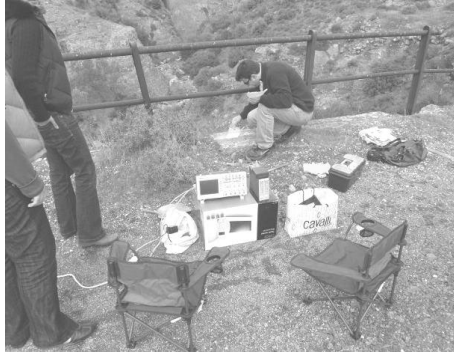
Şekil 4. Zeytinler kemer köprü darbe-eko testi Zeminde İncelemeler
