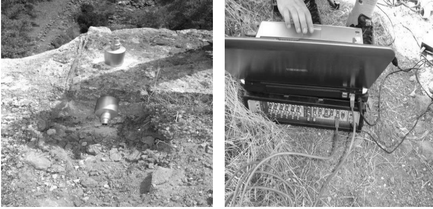
Şekil 7. Kemer köprü ivmeölçerlerin yerleştirilmesi ve veri toplama cihazı
