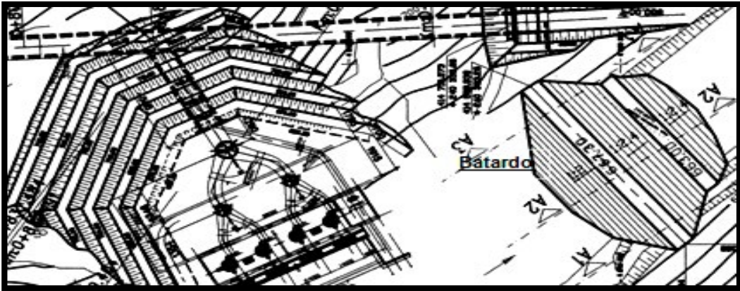
Şekil 13. Köprü Barajı HES ve akış aşağısı batardosu. (Köprü Barajı Projesinden)
