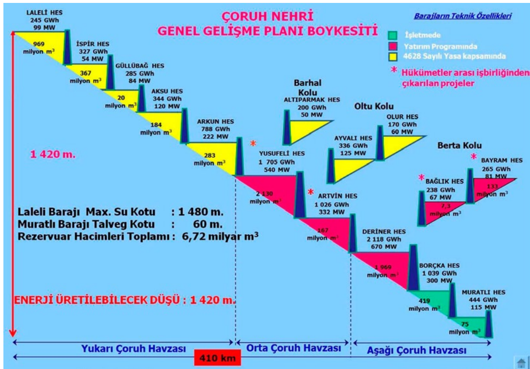
Şekil-2 Çoruh Nehri üzerindeki barajların boykesiti.
