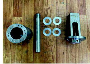
(a) KES bileşenleri (sırasıyla çelik tüp, çıkıntısız şaft, pul, kapak)
