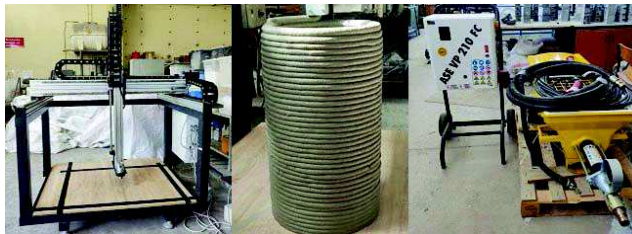
Şekil 1. DEÜ Yapı Malzemesi Laboratuvarı'nda yer alan 3B harç yazıcısına ait görseller
