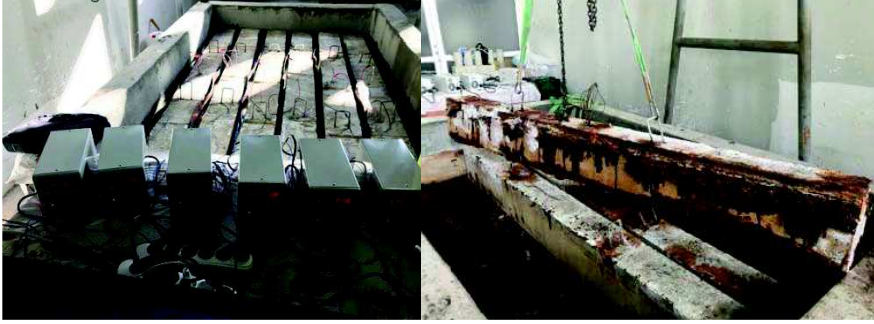
Şekil 3. Hızlandırılmış korozyon test düzeneği
