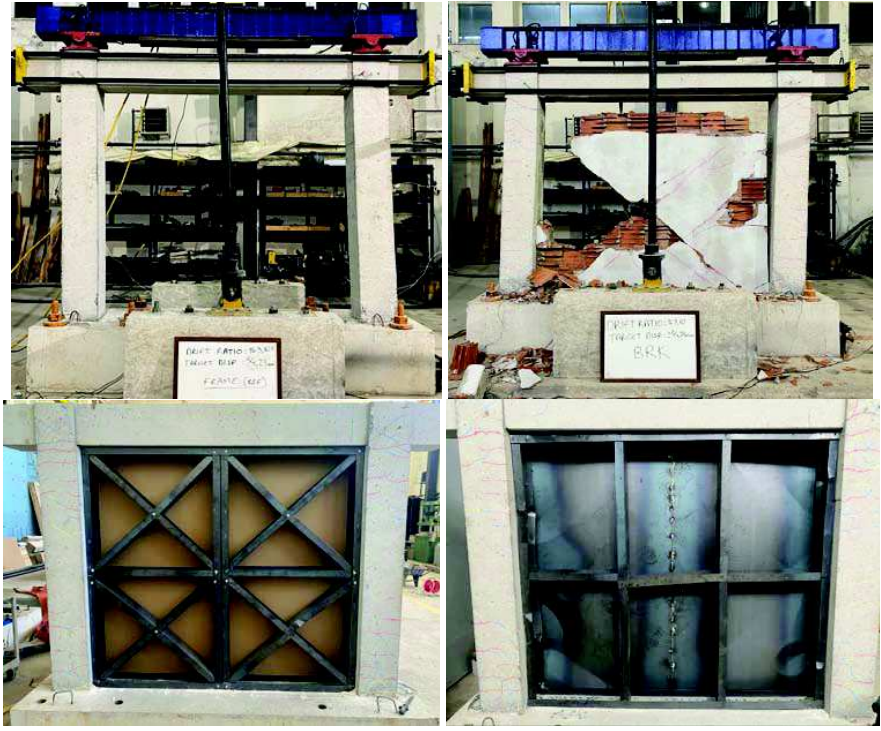
Şekil 4. Deney elemanlarındaki hasar durumu
