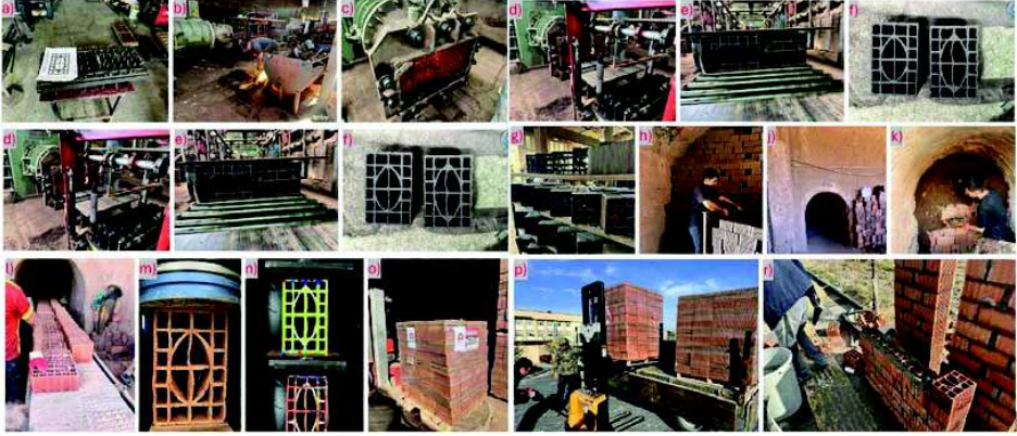
Şekil 4. Geliştirilen tuğla prototiplerinin kalıp hazırlığından üretim, kurutma, pişirme, test, paketlenme ve sevk aşamalarına kadar uzanan üretim süreci
